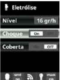
Choque: Filtragem contínua durante 24 horas com intensidade máxima. Regresso automático ao modo de filtragem programado. Durante o período de choque, o controlo por Redox pode ser desativado.
